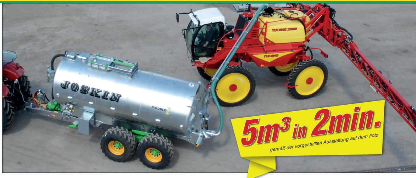
Ein JOSKIN Fass MODULO2 14.000 ausgestattet um eine Leistungserhöhung von großen Feldspritzen in der Hochsaison zu ermöglichen.
